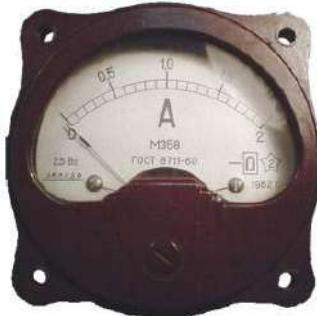
Амперметр М358 предназначен для измерения постоянного тока. Приборы применяются для монтажа в подвижных и стационарных радио- и электроустановках.
