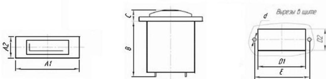
A1 - 52мм, A2 - 20мм, B - 41мм, C - 12мм, D1 – 40,5мм, D2 – 21мм, d – 3,4мм, E – 46мм.
