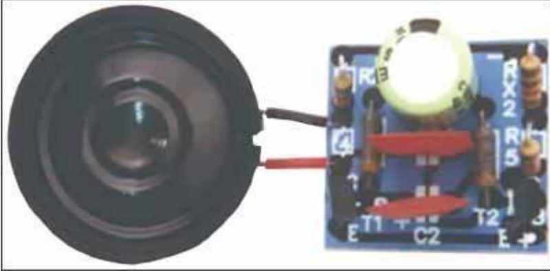
Очень простое и надежное устройство, которое под силу собрать даже Вашему ребенку. Эту охранную систему можно использовать не только в детских играх, но и приспособить для защиты различных объектов: чемоданов, шкафов и т.п. Схема питается от батарейки постоянным напряжением 9 В. Размеры печатной платы 25x24 мм.
