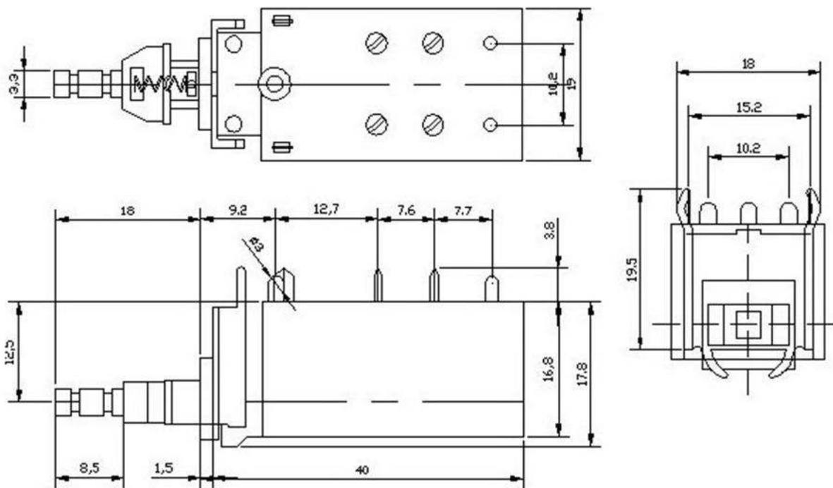
Сетевой выключатель имеет три группы контактов: две силовые группы, с максимальным током нагрузки 4 ампера и рабочим напряжением до 250 вольт, и одной слаботочной группой, с рабочим напряжением 24 вольт и током нагрузки до 100 мА.
