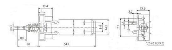
Сетевой выключатель имеет две группы контактов с максимальным током нагрузки 4 ампера для каждой группы.
