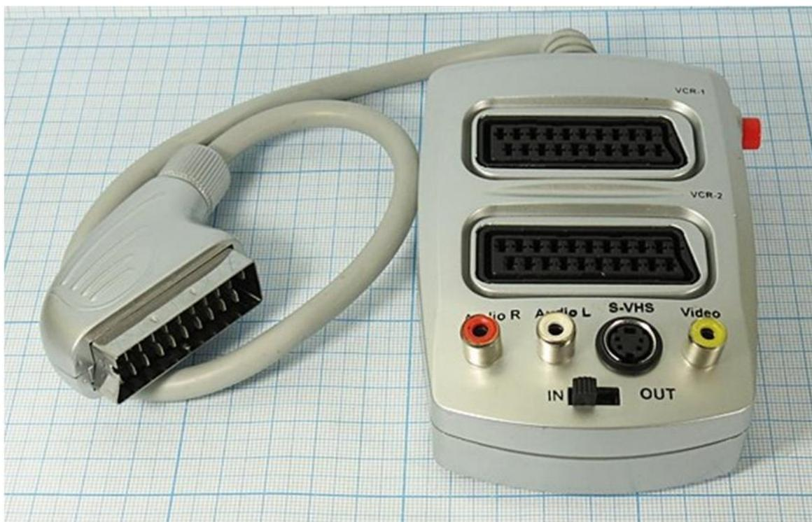
Шнур представляет из себя кабель длиной 30 сантиметров, заделанный с одной стороны штекером SCART, с другой стороны мини панелью. На панель выведены два гнезда SCART, три гнезда RCA, гнездо стандарта S-VHS и переключатель «вход-выход».
