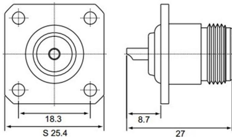
**Разъем имеет позолоченный центральный проводник и хромированный корпус (реже посеребренный). Изолятор, как правило, изготовлен из фторопласта или из бакелита.**
